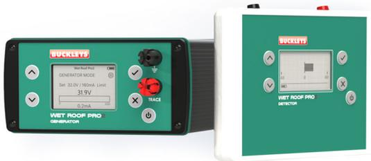
Le Wet Roof Pro2 génère du courant électrique dans l'eau à la surface du toit. Les fuites dans la membrane du toit permettent à l'eau de s'écouler et d'entrer en contact avec les zones mises à la terre de la structure ; compléter un circuit électrique.
