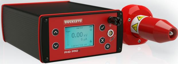
Disponible en sorties 6 kV, 30 kV et 40 kV et en trois formats de kit (Basic, Standard / Pipeline ou Complete); le PHD Pro2 répond à une variété d'applications et la large gamme d'accessoires et d'électrodes disponibles permet au PHD Pro2 de s'adapter aux exigences de test spécifiques.
