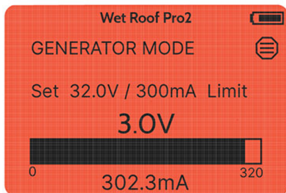
Fig. 5 Écran d'accueil – courant supérieur au seuil
