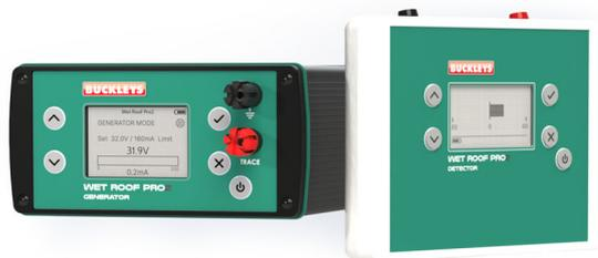
O Wet Roof Pro2 gera corrente elétrica dentro da água na superfície do telhado. Vazamentos na membrana do telhado permitem que a água flua e entre em contato com áreas aterradas da estrutura; completando um circuito elétrico.
