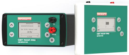
El Wet Roof Pro genera corriente eléctrica dentro del agua en la superficie del techo. Las fugas en la membrana del techo permiten que el agua fluya y entre en contacto con áreas de la estructura conectadas a tierra; completar un circuito eléctrico.
